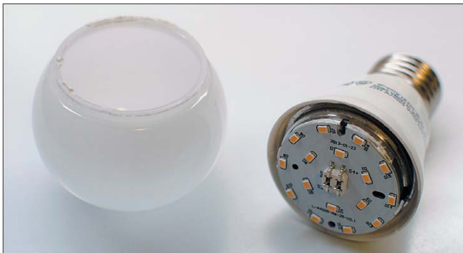
Рис. 8. КПД оптической системы этой лампы составляет 90%, что было бы невозможно при плоской форме светильника с рассеивателем той же степени матовости
