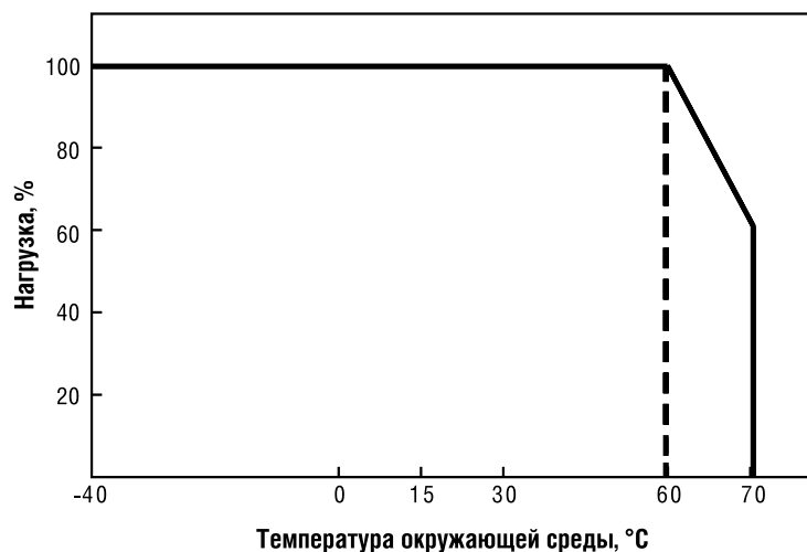
Рис. 2. Зависимость выходной мощности источника питания от температуры окружающей среды (на примере HLG-100H при горизонтальном расположении модуля)
